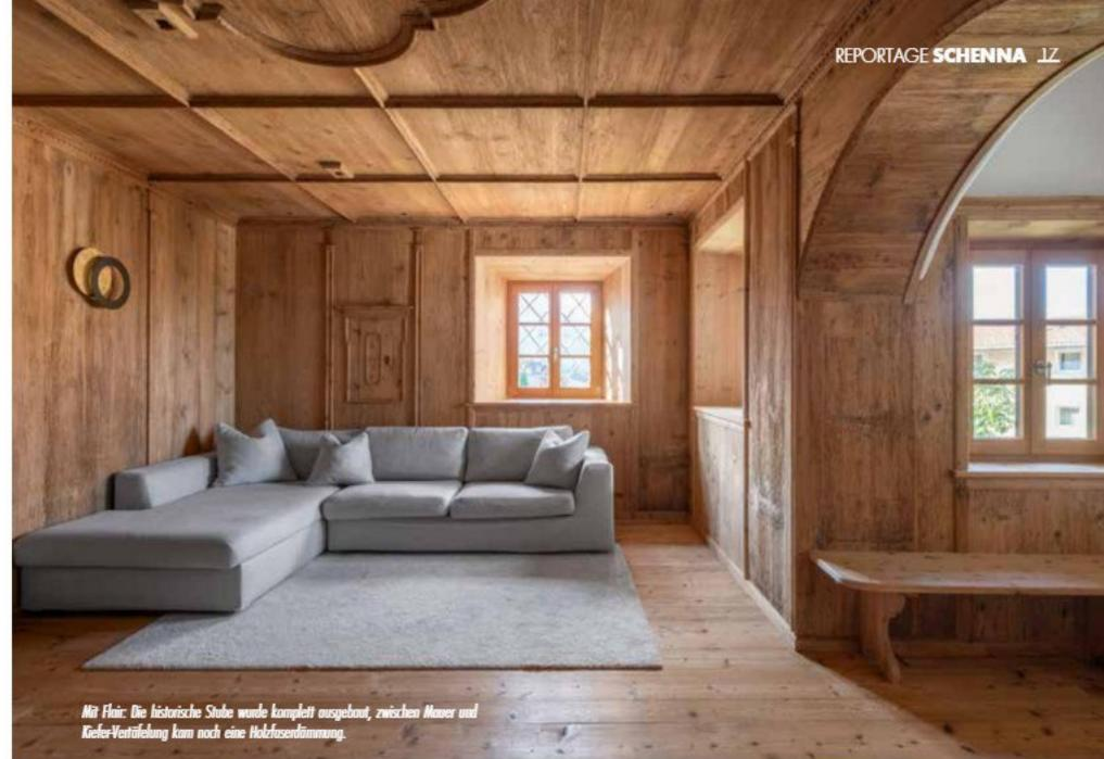
Mit Flair: Die historische Stube wurde komplett ausgebaut, zwischen Mauer und Kiefer-Vertäfelung kam noch eine Holzfaserdämmung.
